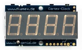
4-stelliges 7-Segment-Uhr Modul. Terminal Print- und Fehler-Ausgabe über USB. Integrierte Echtzeit- uhr mit Stützbatterie. 4 Taster auch über Lötpunkte als Eingangspins zu verwenden. Anschluss für Miniatur-Lautsprecher zur Signalausgabe ist auf dem Board vorhanden. Stromversorgung über USB-Anschluss oder über die Lötpunkte +5V und GND.
