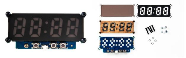
Bausatz für eine 4-stellige 7-Segment-Uhr mit farbigen Ziffern, bestehend aus SK6812-Mini-LEDs. Terminal Print- und Fehler-Ausgabe über USB. Integrierte Echtzeituhr mit Stützbatterie, 3 Tasten oder Eingangspins, 3 Ausgangspins für Schaltsignale, LDR und Lautsprecher sind auf dem Board vorhanden. Anschluss für optionalen Temperatursensor DS18B20. Stromversorgung über USB-Anschluss. Zusätzlich zu fest verdrahteten 30 LEDs können über den Ausgang (Dout) bis zu insgesamt 256 LEDs angesteuert werden.
