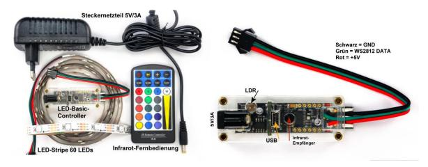
Spezialschaltung zur Steuerung von WS2812-Stripes mit Infrarot-Fernbedienung. Die LED-Box beinhaltet den LED-Basic-Controller, einen LED-Stripe mit 60 LEDs, Infrarot-Fernbedienung und Netzteil. Ideal für Effektbeleuchtungen in der Wohnung. Über den LDR sind Helligkeitsanpassungen des Stripes abhängig von der Umgebungshelligkeit möglich. EEPROM mit 8 Speicherstellen. Terminal Print- und Fehler-Ausgabe über USB. Stromversorgung über 5V/3A Steckernetzteil.
